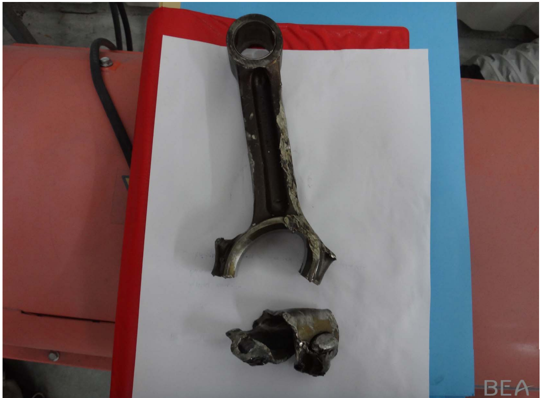
Tête de bielle rompue
