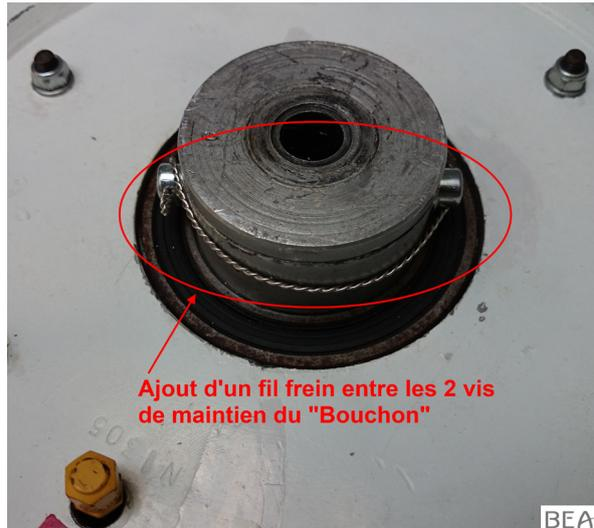
Un risque de desserrage et de perte des vis pendant l'utilisation de l'avion a été identifié et une modification du montage a été apportée. Elle consiste à relier les deux vis par un fil frein afin d'éviter leur desserrage. Le contrôle de la présence de ce fil frein lors de la visite prévol de l'avion facilite la détection d'une anomalie.
