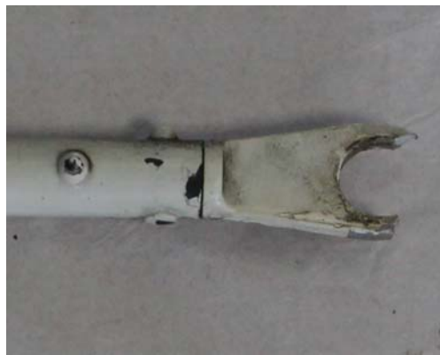
Embout à rotule rompu de la bielle de commande
