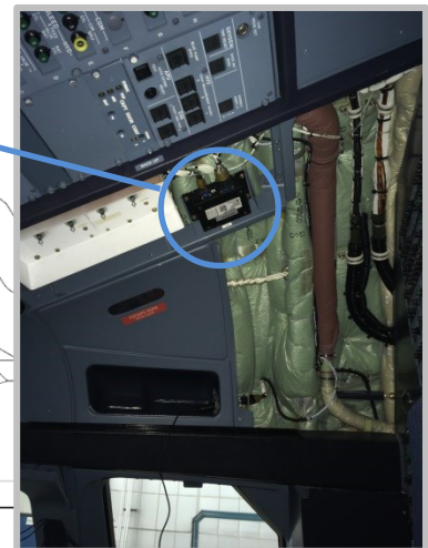
Préamplificateur (CU_ dissimulée sous un panneau d'habillage)
