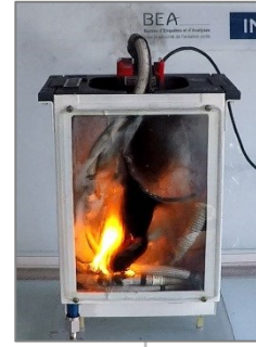
Le feu se propage au harnais et à la protection en Nomex du flexible
