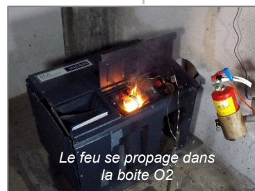
Télé-allumage d'une flamme dans la boîte O2
