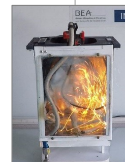
Percement du flexible du masque O2
