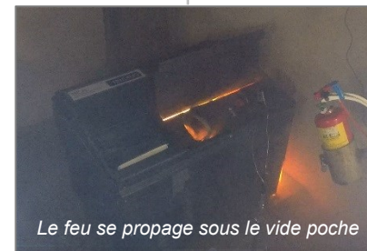
Flammes visibles au pourtour de la boîte O2
