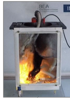
Percement du flexible du masque O2
