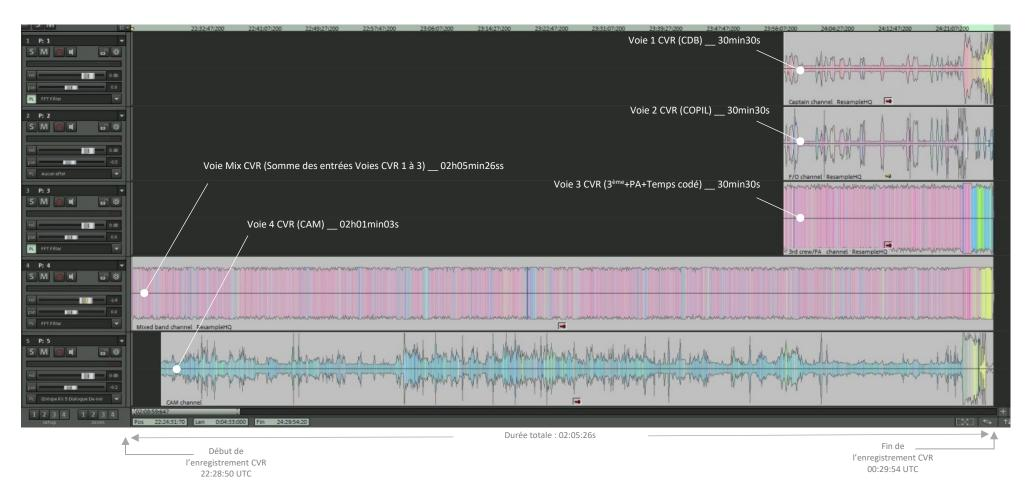
Note: les données CVR ont été synchronisées (référence au temps UTC du FDR) à partir des informations de déclenchement des différentes alarmes et des heures de radiocommunications enregistrées par les services du contrôle (ATC).
