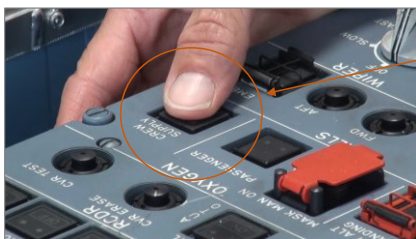
Commande électrique de la DVE (vanne d'alimentation du circuit oxygène)
