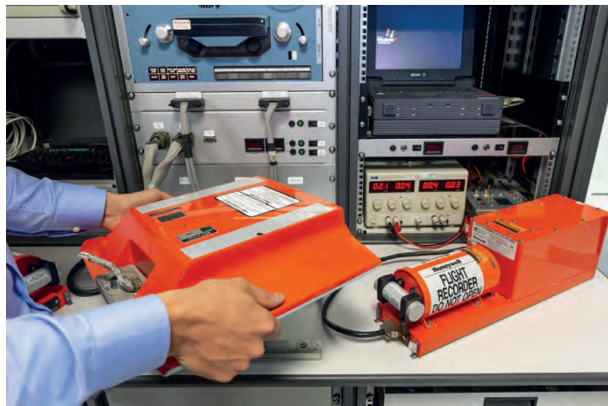
Nouvelle (à gauche) et ancienne (à droite) génération d'enregistreurs de vols.
