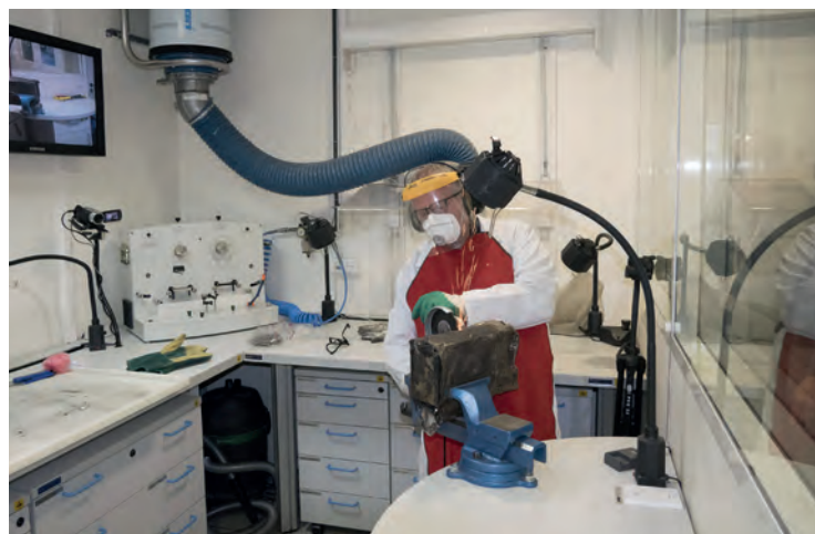
Les laboratoires modernes permettent par exemple l'ouverture des enregistreurs de vol avant leur analyse.
