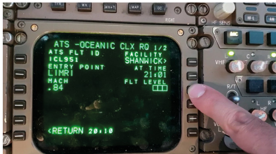
ACARS (Aircraft Communications, Addressing and Reporting System) est un système de communication numérique utilisé sur les avions qui permet d'envoyer et de recevoir des messages au format texte entre les avions et les stations au sol.
