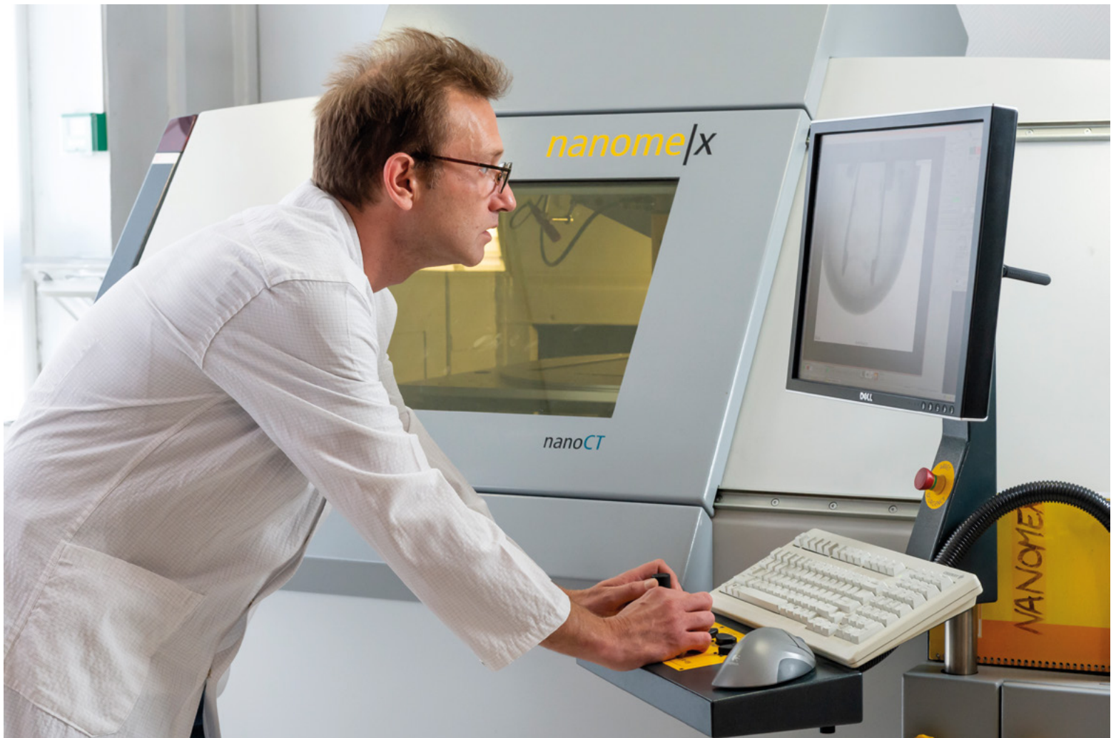
Analyse d'une pièce au tomographe permettant une radiographie à rayons X.
