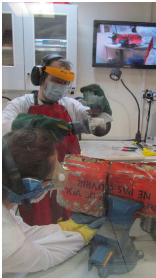
L'ouverture d'un enregistreur, sous l'œil de la caméra afin de certifier les opérations.
