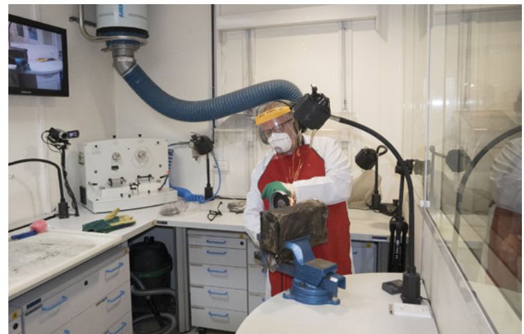
Les laboratoires modernes permettent par exemple l'ouverture des enregistreurs de vol avant leur analyse.
