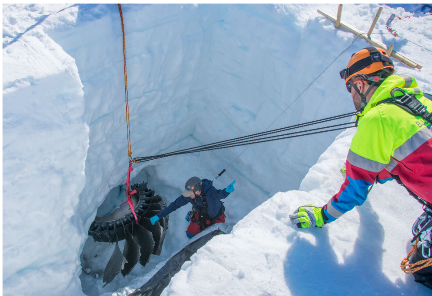
Extraction d'une partie du moyeu de soufflante retrouvée 4 m sous la surface de la calotte glaciaire du Groenland en juin 2019 - Photo Austin Lines
