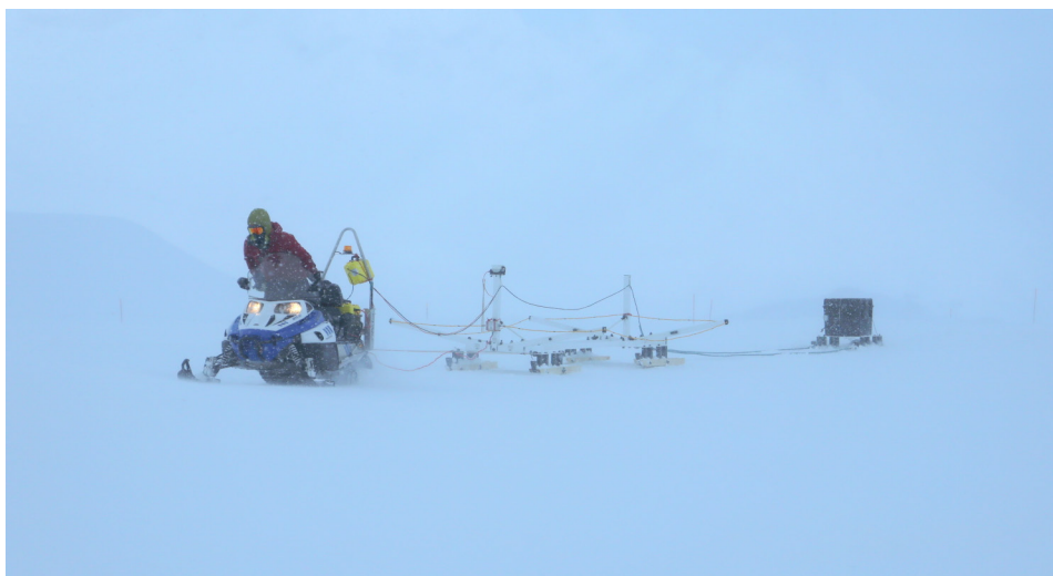
Test du fonctionnement du système électromagnétique SnowTEM sur un glacier à Zermatt (Suisse) en janvier 2019
