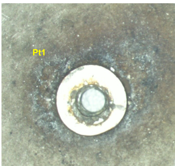
Figure 102 : Point de fixation du plancher de l'avion au droit de la zone fondue du radiateur métallique Source : BEA
