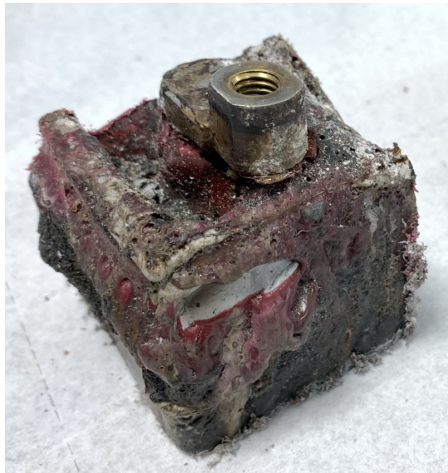
Figure 58 : borne - de la batterie Source : BEA
