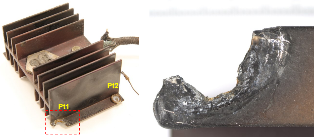
Figure 107 : radiateur métallique et vue de détail de la zone endommagée Source : BEA
