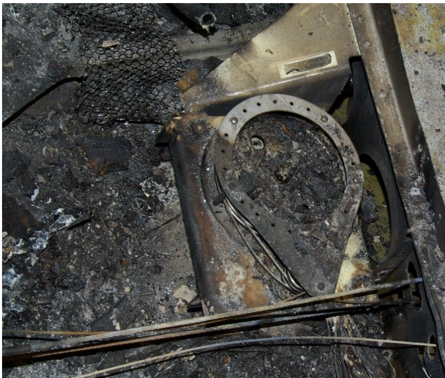
Figure 28 : Servocommande en position Source : BEA
