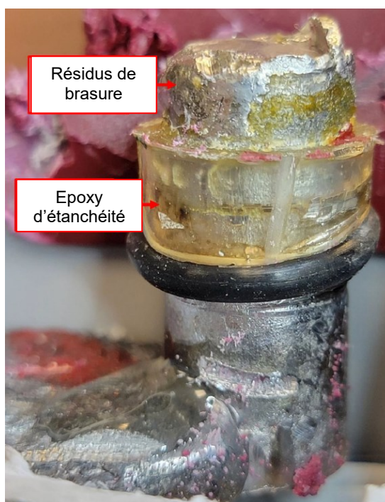
Figure 72 : Détail de la borne après l'essai Source : Concorde Aircraft Batteries
