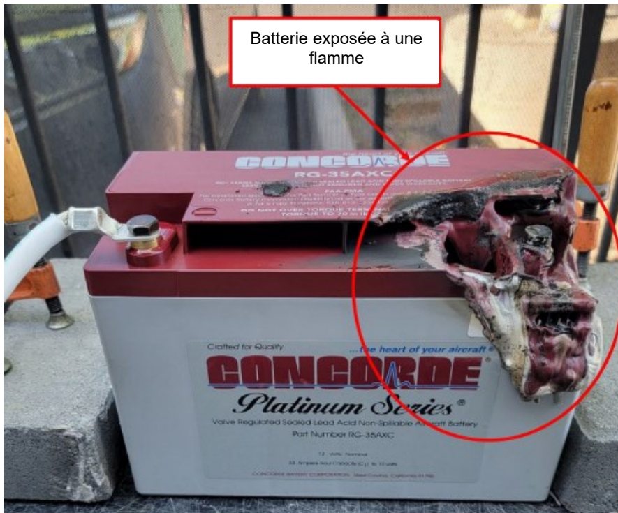
Figure 76 : Désolidarisation des parties 1 et 2 de la borne Source : Concorde Aircraft Batteries
