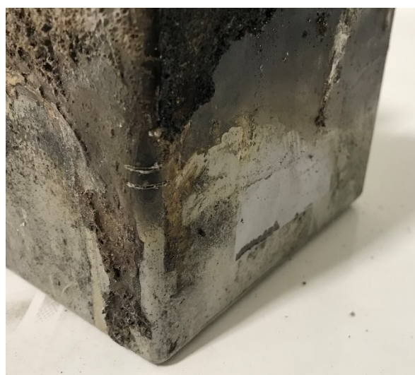
Figure 51 : Partie inférieure de la batterie côté borne - Source : BEA
