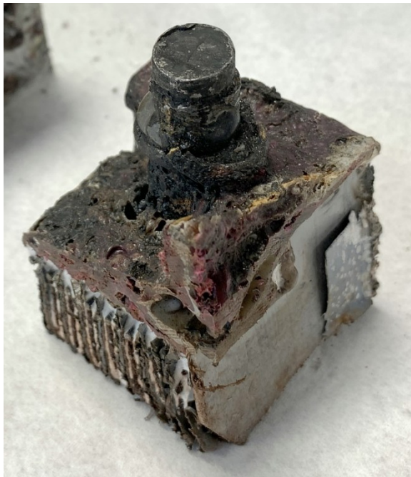
Figure 57 : borne + de la batterie Source : BEA
