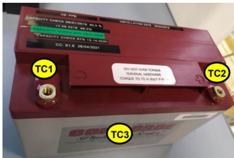
Figure 81 : Position des thermocouples sur la batterie Source : INES CEA
