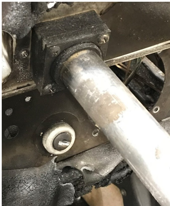
Figure 150 : Commutateur de démarrage en position sur le tableau de bord Source : BEA
