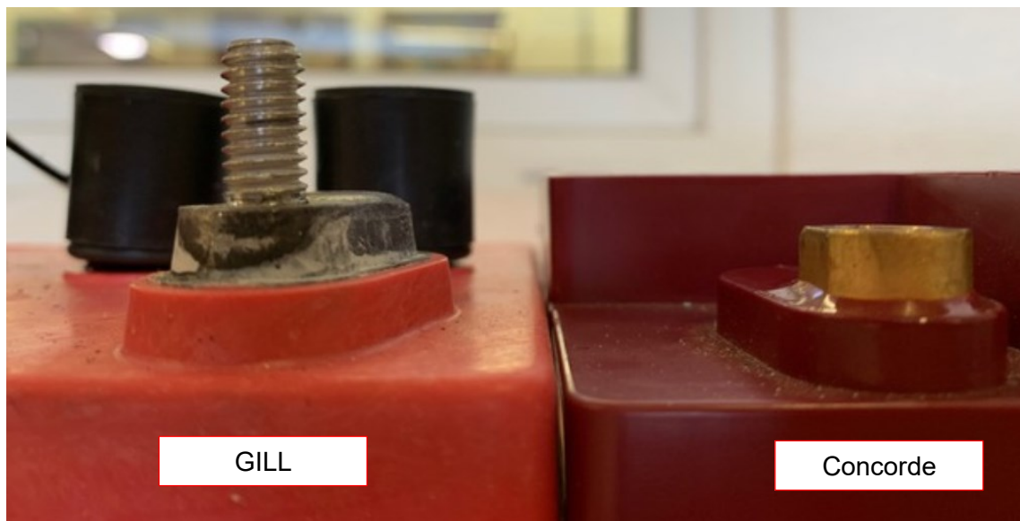
Figure 46 : Comparaison entre une borne d'une batterie GILL et celle d'une batterie Concorde Source : Flugschule Basel AG
