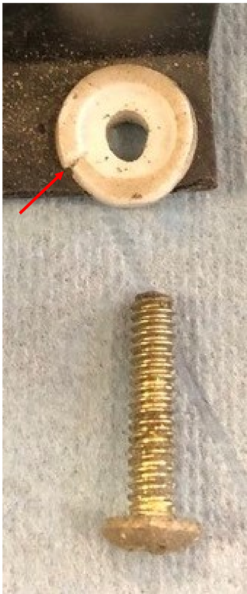
Figure 111 : Collerette supérieure de la rondelle isolante fissurée Source : Atelier entretenant l'avion HB-PPB
