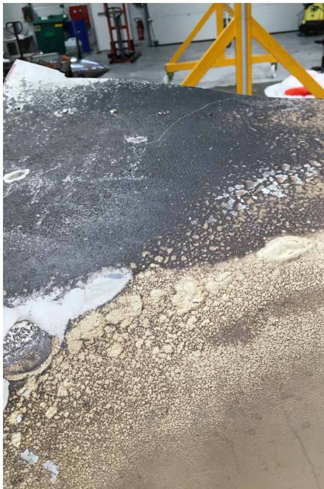
Figure 12 : Détail de l'état de la peinture externe Source : BEA
