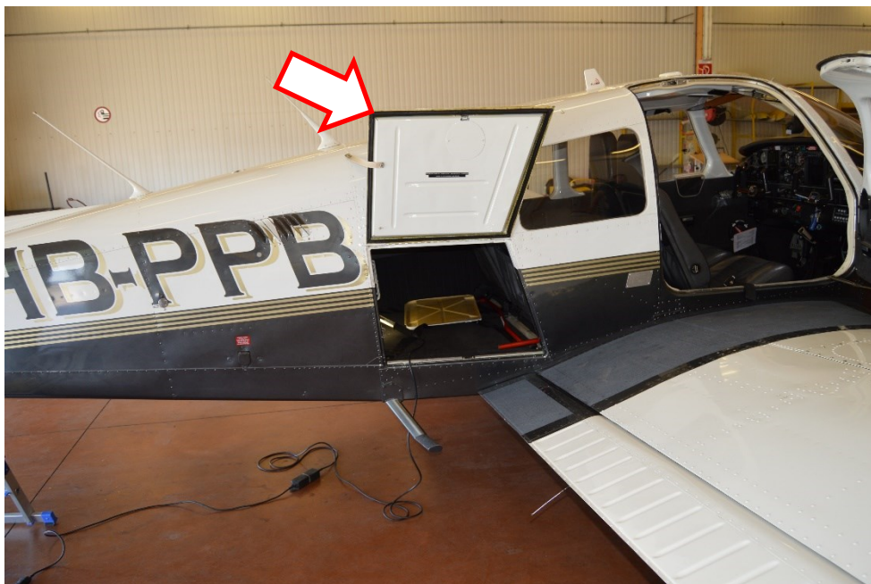
Figure 21 : Porte d'accès à la soute à bagages
