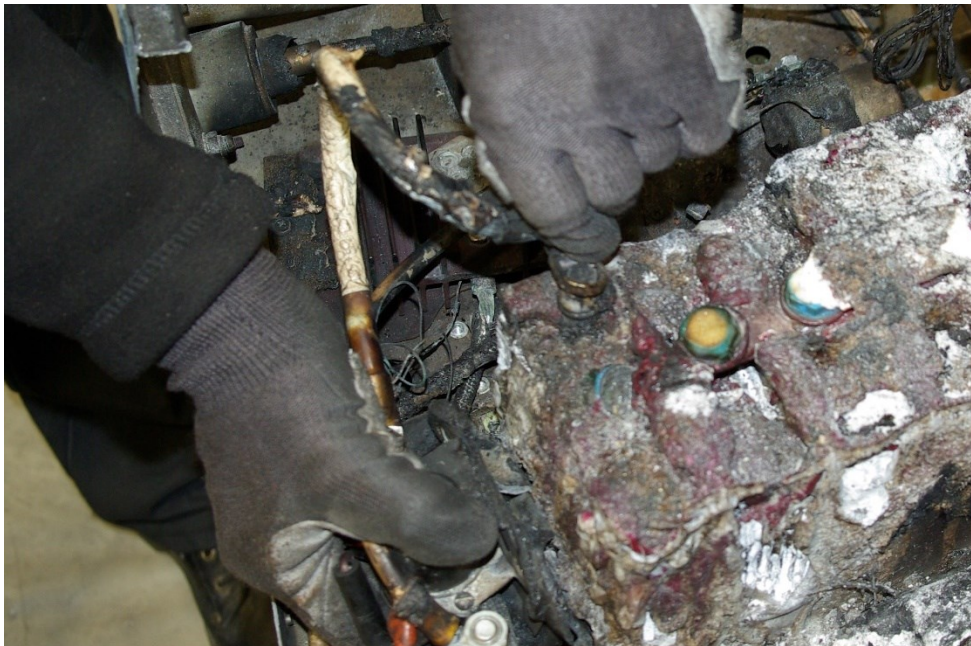
Figure 55 : Repositionnement du conducteur sur la borne + de la batterie Source : BEA
