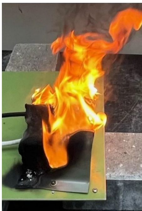
Figure 125 : Capot en ABS se consumant
