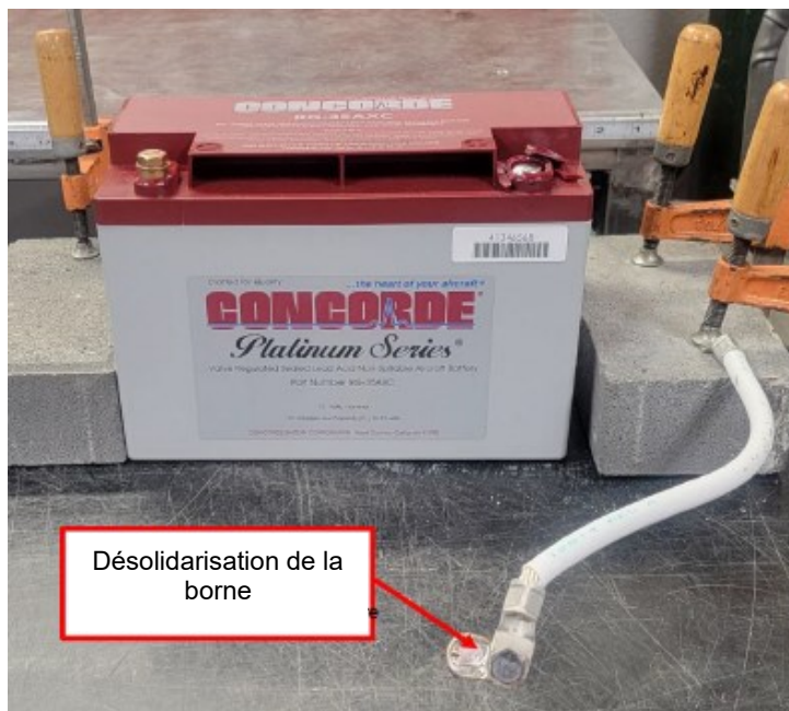
Figure 74 : Désolidarisation des parties 1 et 2 de la borne Source : Concorde Aircraft Batteries
