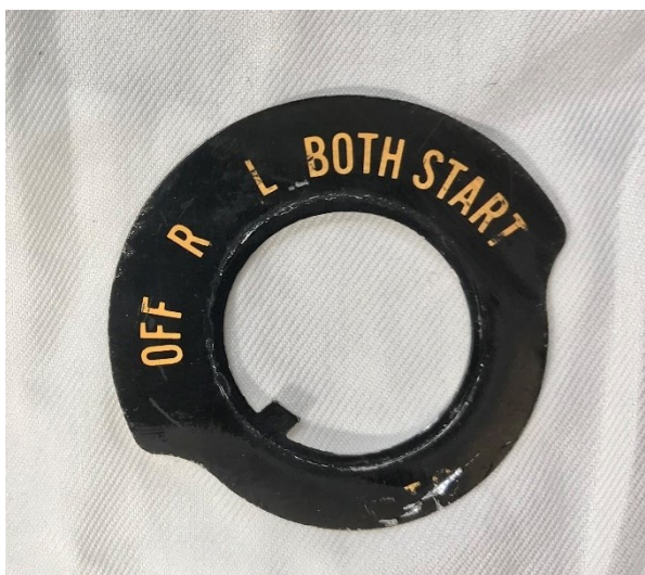
Figure 149 : Plaquette positionnée au droit du commutateur de démarrage, indiquant les cinq positions possibles
