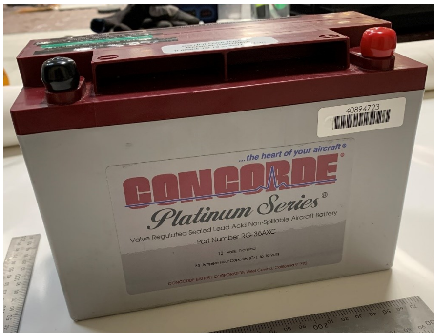
Figure 78 : Batterie déposée de l'avion HB-PPB Source : BEA
