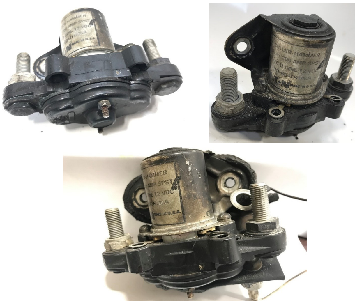
Figure 135 : Master Solenoid Source : BEA
