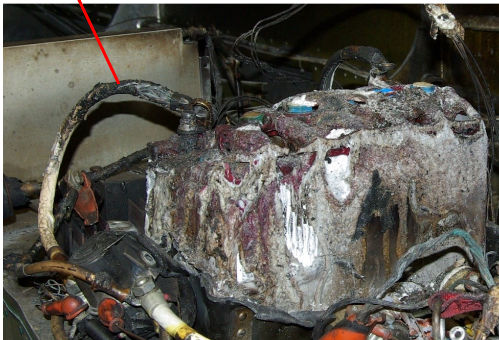
Figure 65 : Conducteur associé à la borne + de la batterie Source : BEA
