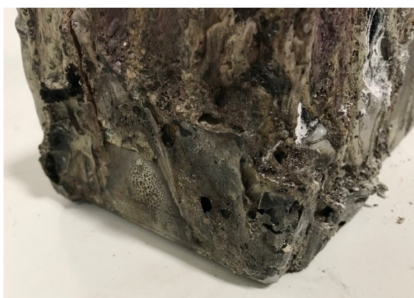
Figure 50 : Partie inférieure de la batterie côté borne + Source : BEA
