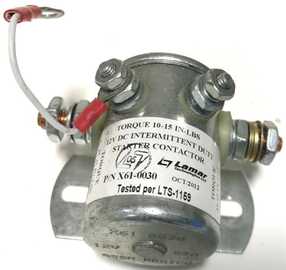
Figure 154 : Starter Solenoid déposé de l'aéronef Source : BEA
