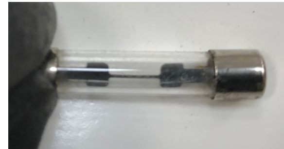
Figure 106 : Fusible 5A associé au dispositif à diode Source : BEA
