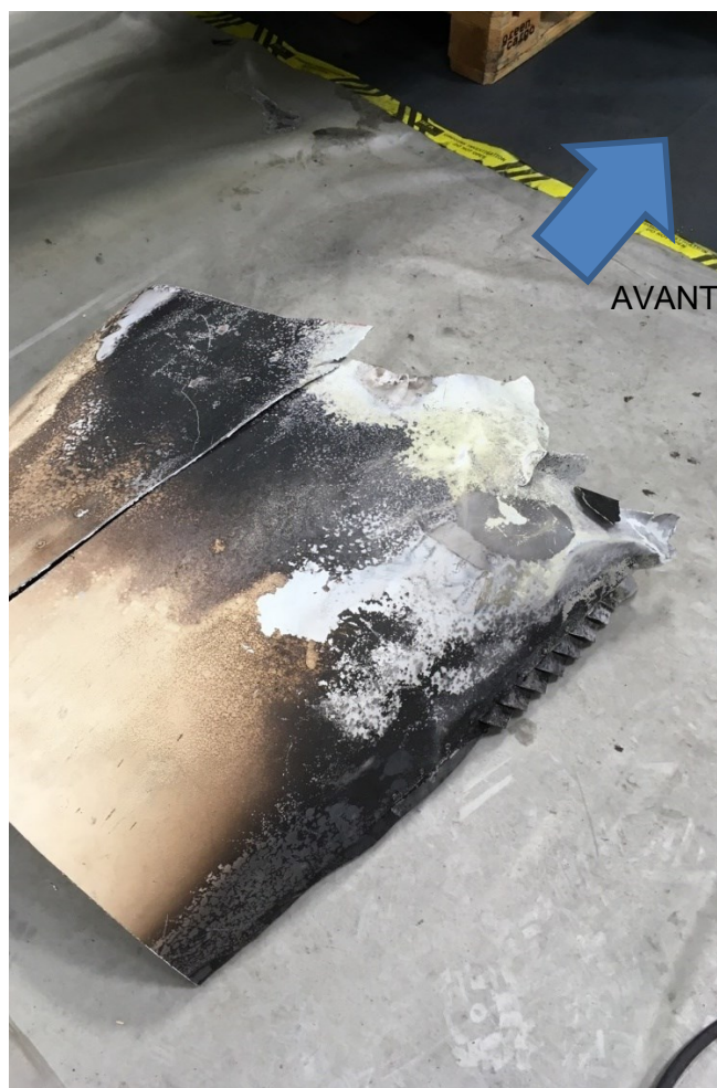
Figure 11 : Zone où la peinture externe de la tôle est endommagée ou détruite sur la partie supérieure de l'avion
