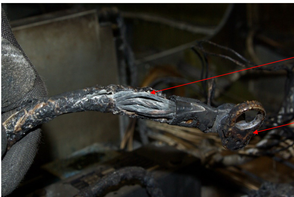
Figure 54 : Conducteur associé initialement à la borne + de la batterie Source : BEA
