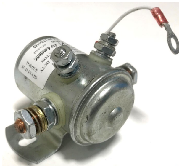
Figure 155 : Starter Solenoid déposé de l'aéronef Source : BEA
