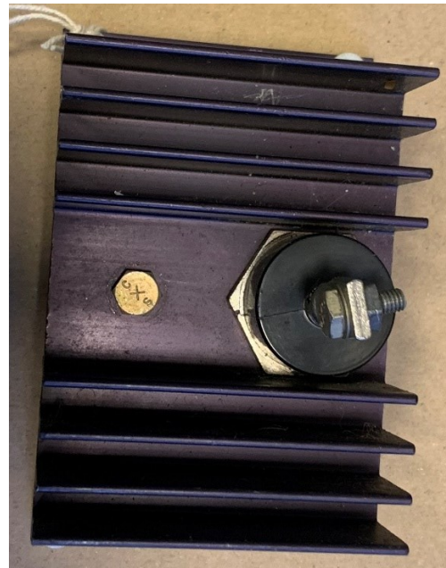
Figure 95 : Dispositif à diodes fourni au BEA par Concorde Aircraft Batteries 19
