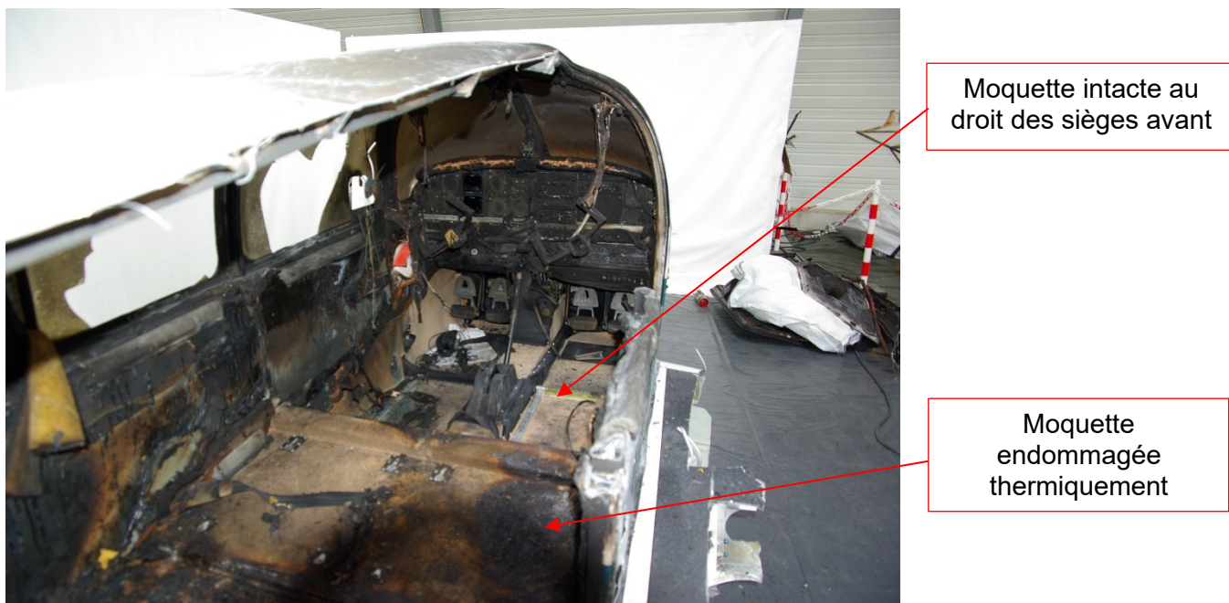
Figure 17 : Habitacle après la découpe du fuselage et le dégagement des sièges Source : BEA
