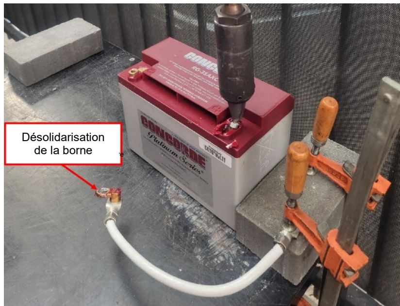
Figure 71 : Désolidarisation des parties 1 et 2 de la borne Source : Concorde Aircraft Batteries
