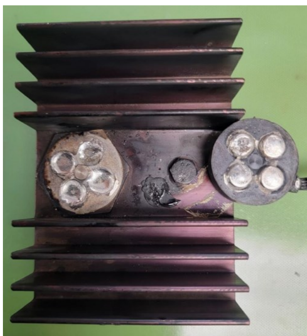
Figure 127 : Séparation du pont de diodes du radiateur métallique Source : Concorde Aircraft Batteries
