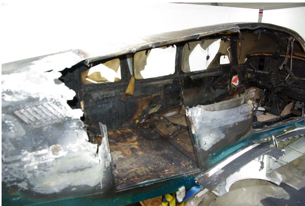
Figure 18 : Habitacle après la découpe du fuselage et le dégagement des sièges Source : BEA
