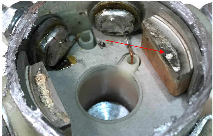
Figure 159 : Indices d'arcs électriques en fonctionnement Source : BEA
