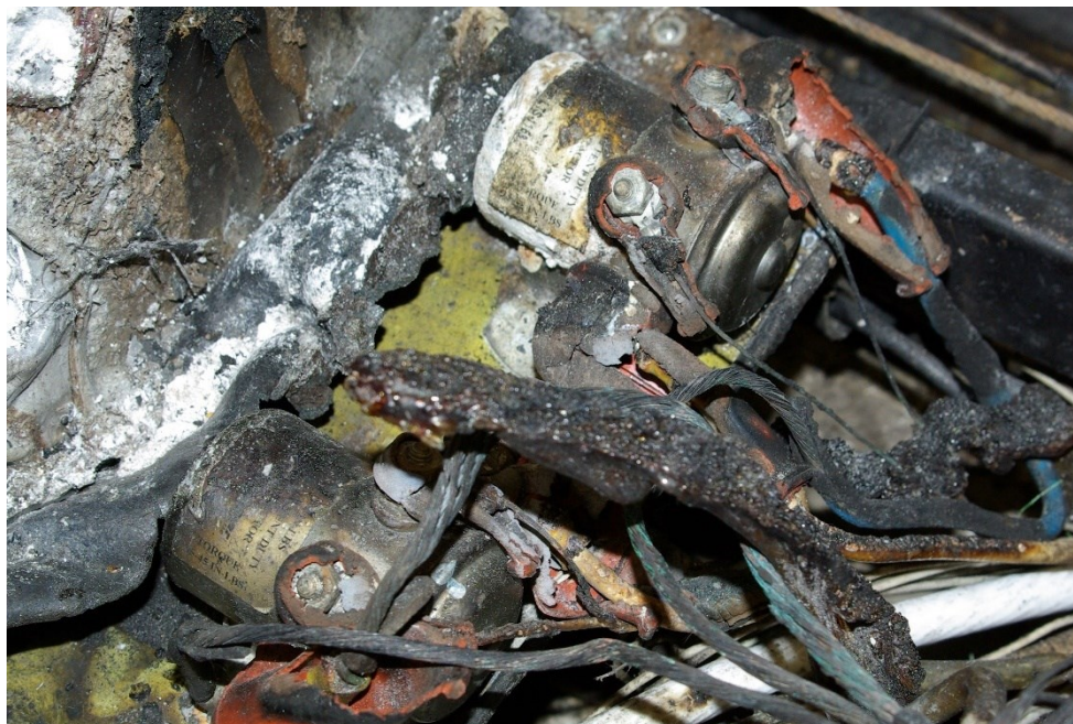
Figure 31 : Contacteurs situés devant la batterie Source : BEA
