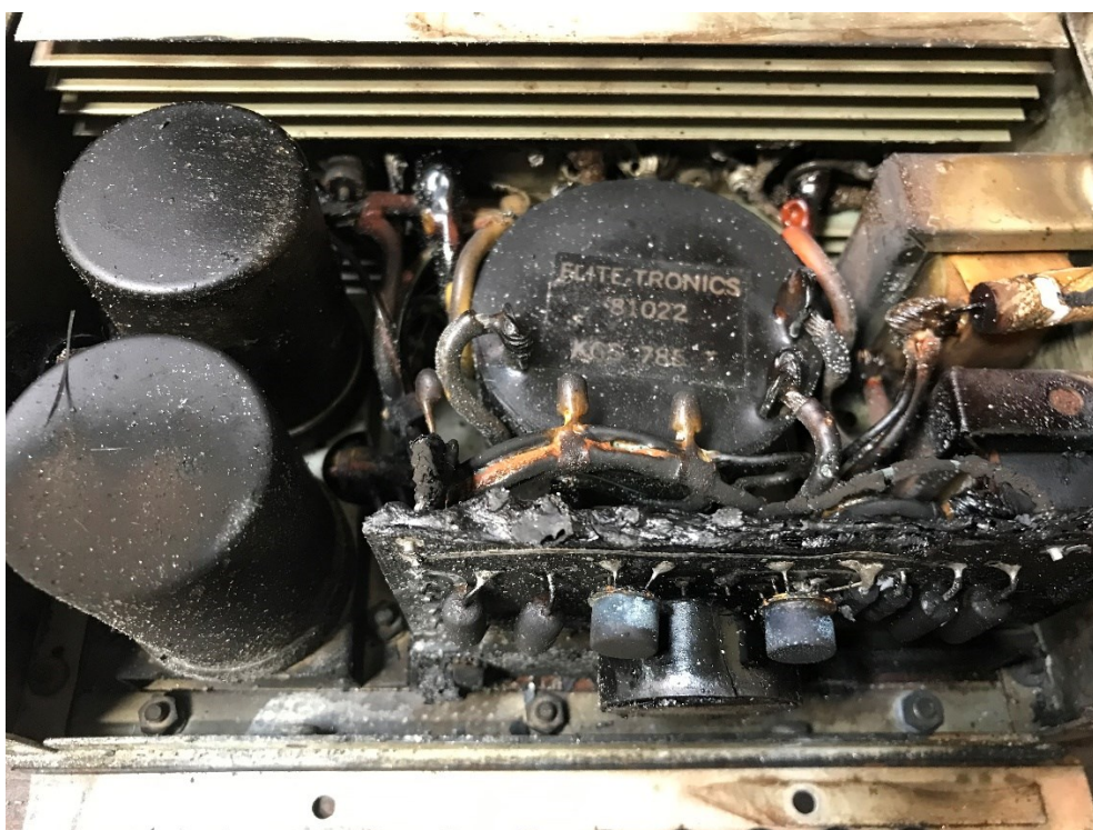
Figure 34 : Composants du convertisseur 12 V - 24 V Source : BEA
