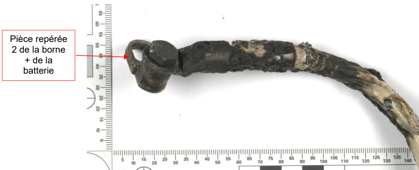
Figure 66 : Conducteur associé à la borne + de la batterie, avec connecteur Source : BEA
