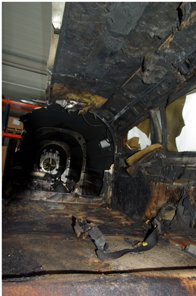
Figure 19 : Habitable après la découpe du fuselage et le dégagement des sièges Source : BEA
