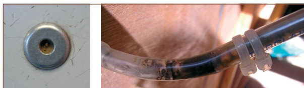
Exemples de dépôts causés par des insectes. Ceux situés dans le tube ne sont pas décelables à la visite pré-vol.
