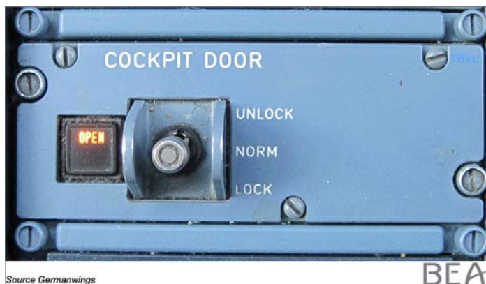
Figura 5 - conmutador de la puerta de la cabina de vuelo
