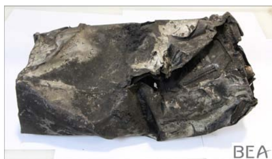
Figura 10 - registrador de datos de vuelo (FDR) - D-AIPX
