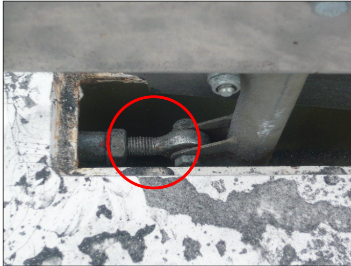
Figure 4 : visibilité du contrôle du montage avec les aérofreins sortis
