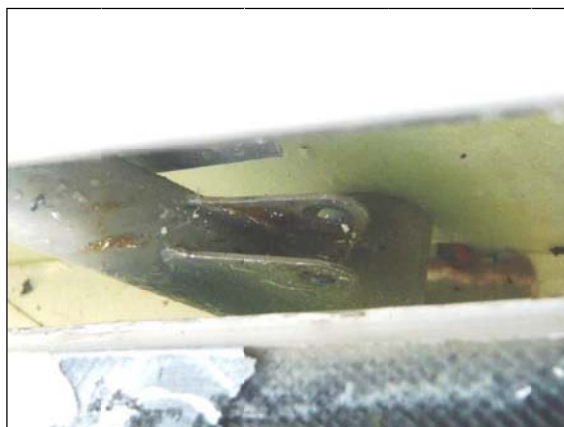
Figure 2 : liaison bielle-levier côté droit
