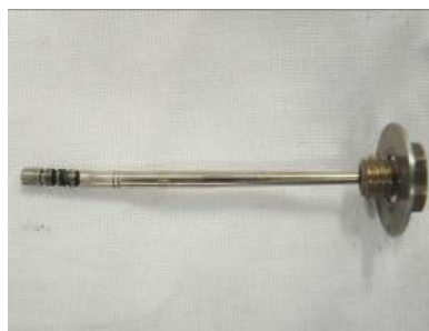
Figure 6 : Aiguille déformée et bloquée dans le gicleur du carburateur droit
