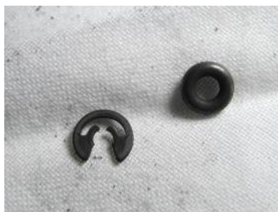
Figure 5 : Anneau élastique et joint récupérés dans le cylindre du carburateur droit
