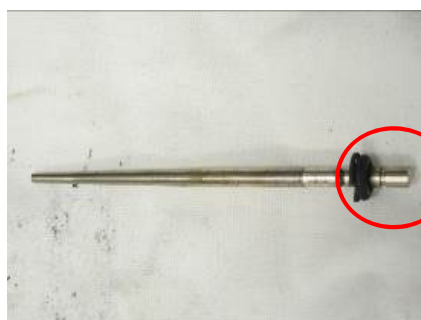
Figure 7 : Aiguille avec l'anneau élastique et le joint en place (carburateur gauche)
