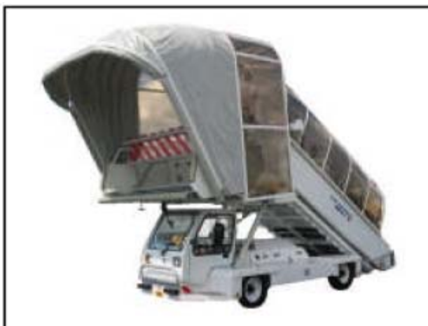
Figure 1 : un escalier autotracté de type ABS580
