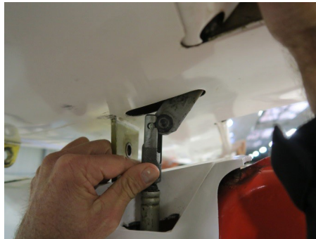
Figure 7 : Mise en place de l'axe du guignol de profondeur sur l'extrémité de la bielle (manchon vers le bas)
