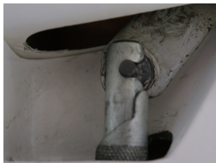
Figure 7 : Mise en place de l'axe du guignol de profondeur sur l'extrémité de la bielle (manchon vers le bas)
