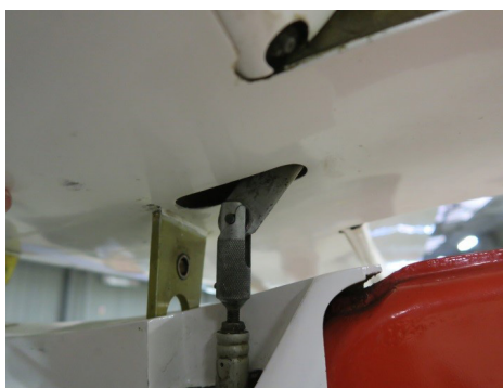
Figure 9 : Liaison effectuée et manchon verrouillé par la gâchette en position haute (liaison sécurisé)
