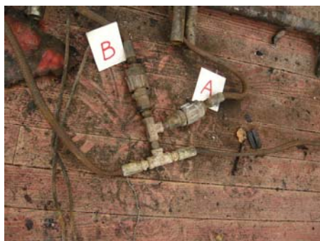
Figure 4 : raccord en double T d'alimentation des brûleurs A et B
