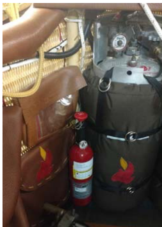
Figure 6 : installation de l'extincteur selon l'option proposée par FireFly Balloons
