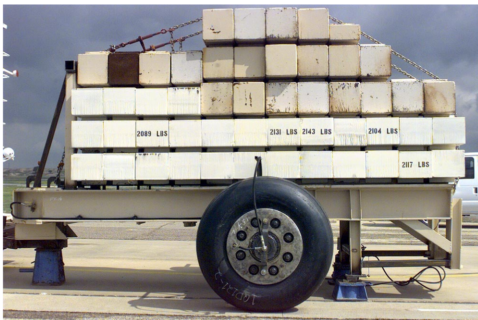
Figure 22 : installation d'essai des pneus
