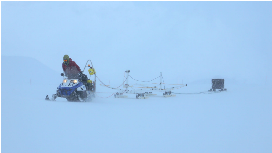
Fig. 35 : SnowTEM tracté par une motoneige durant le test à Zermatt, par conditions de faible visibilité pendant une tempête de neige.
