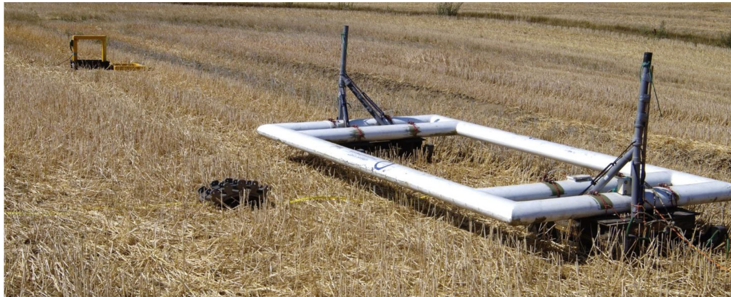
Fig. 29: Photo de la configuration de test : le fragment de moyeu de test est placée à 2 m du centre du cadre de l'émetteur
