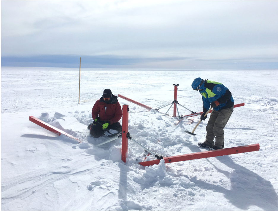
Fig. 36 : Travaux de libération de l'un des deux systèmes SnowTEM après une tempête de neige
