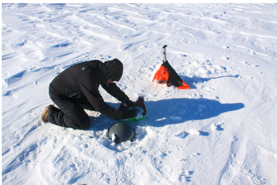
Figure 47 : membre de la GEUS enfouissant la sphère de Luneburg sur la calotte glaciaire
