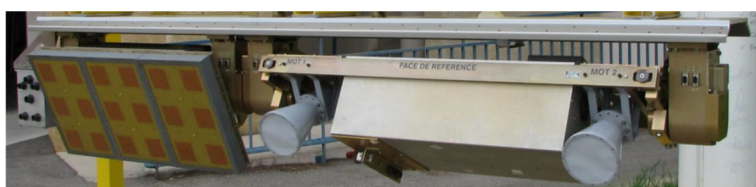
Figure 39 : Charge utile de radar en bande X (droite) et bande L (gauche) intégrée au pod de droite
