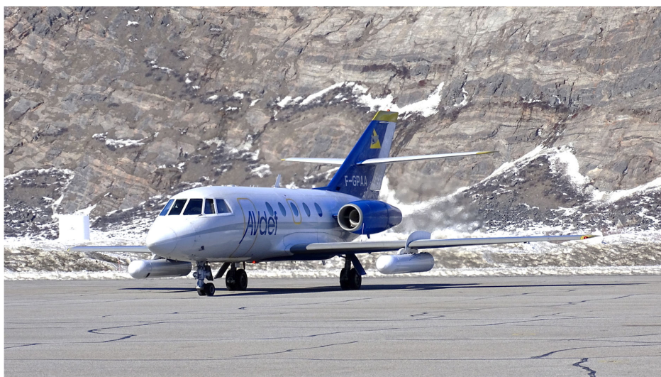
Figure 68 : Falcon 20 Avdef équipé de ses deux pods radar, de retour à l'aéroport de Kangerlussuaq
