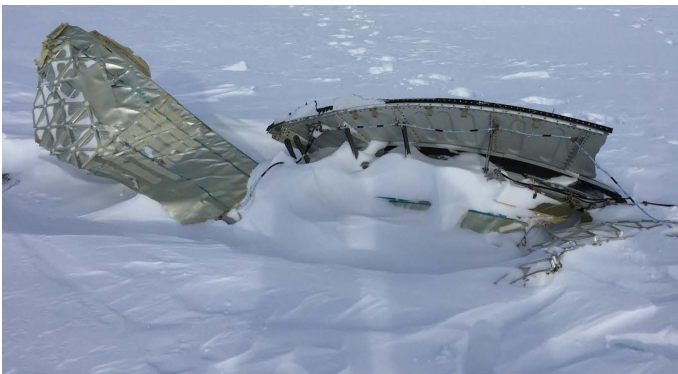
Figure 10 : cloison arrière de capot d'entrée d'air et fragment de carter de soufflante
