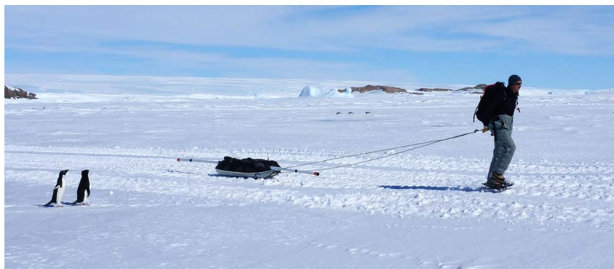
Figure 35 : exemple d'utilisation de l'EM31-MK2 en présence de glace
