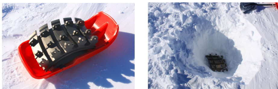
Figure 48 : partie d'un moyeu de soufflante de test sur sa luge, appelée ci-après « moyeu de test » (photo de gauche), et une fois enfouie (photo de droite)
