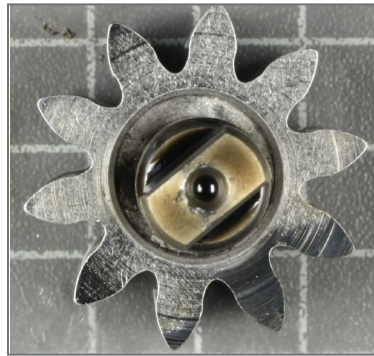
Figure 6 : pignon menant, arbre et morceau du palier soudés par friction (grippage) - cas C
