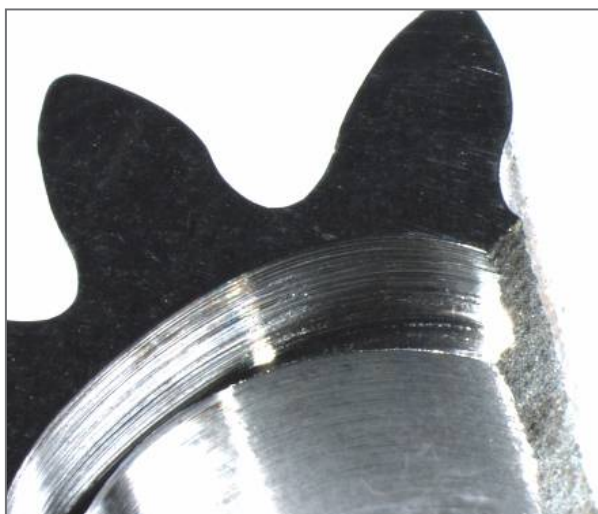
Petite zone de frottement/usure : aspect rayures et sans coloration
