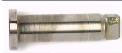
Frottements circulaires sur le corps de l'arbre, localisés en vis-à-vis du palier
