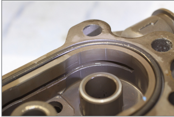
Figure 7 : empreintes des sommets des dents du pignon menant sur les flancs du corps de pompe
