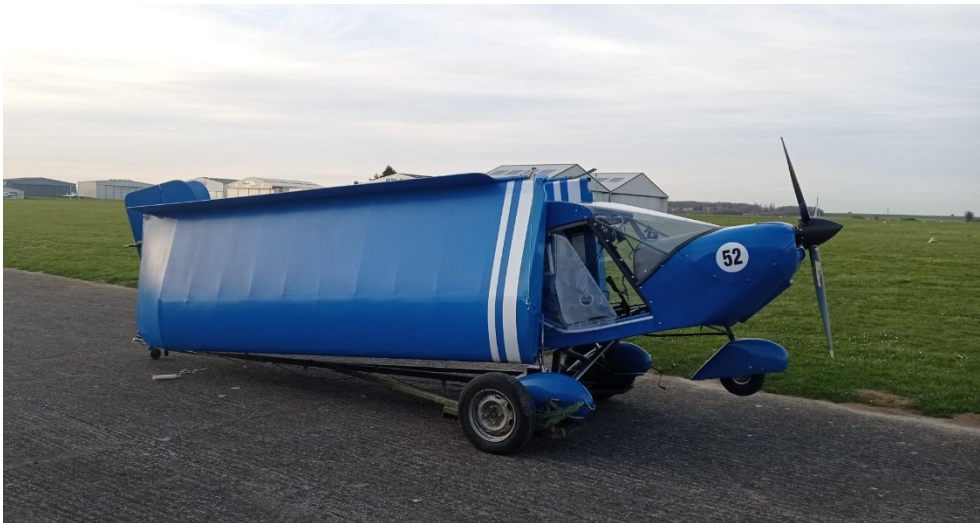
Figure 1 : Pti'tavion avec les ailes repliées le long du fuselage pour être transporté grâce à un chariot (Source : propriétaire d'un Pti'tavion)
