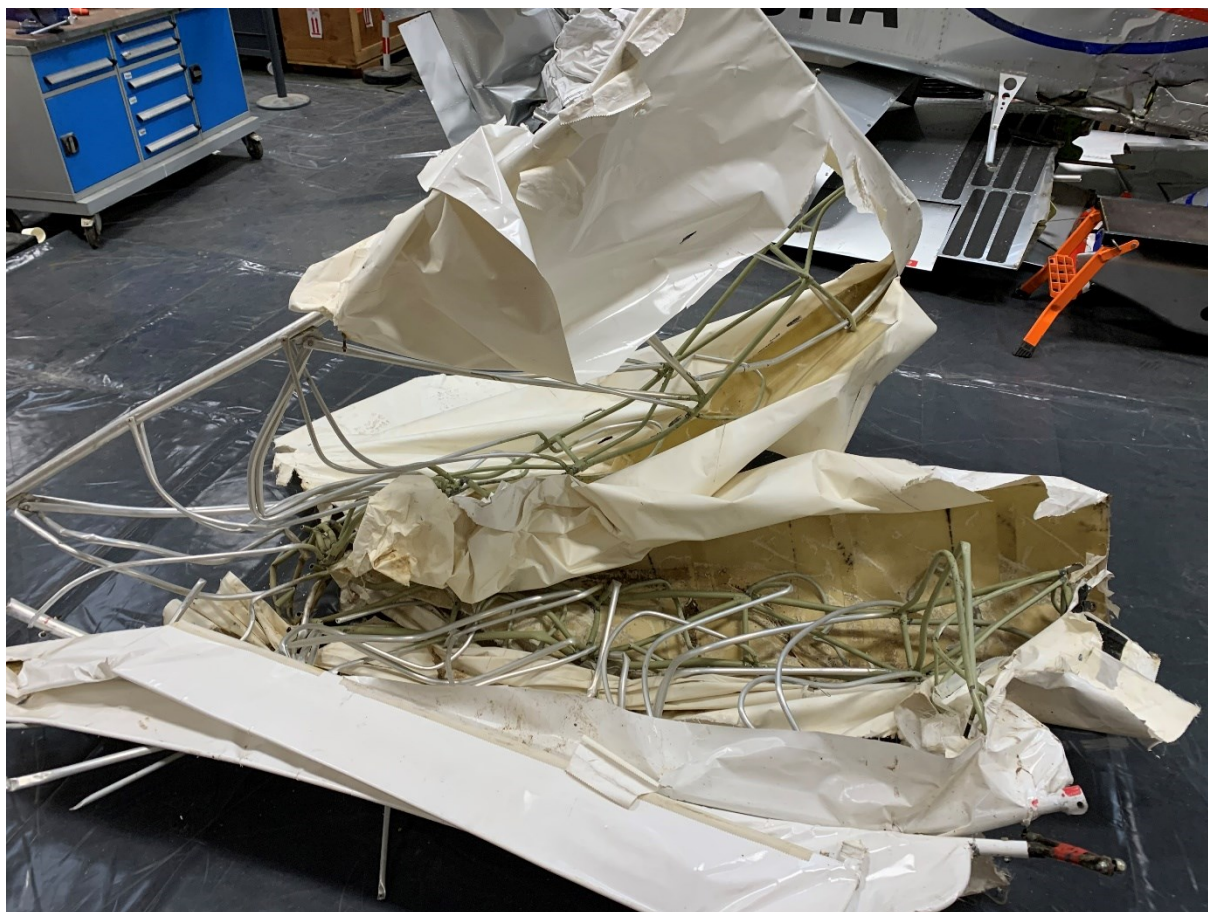
Figure 7 : vue de l'aile gauche partiellement désentoilée du 03AEG (Source : BEA)
