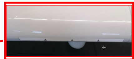
Figure 5 : plan d'installation des stall-strips (Source : Aerospool)
