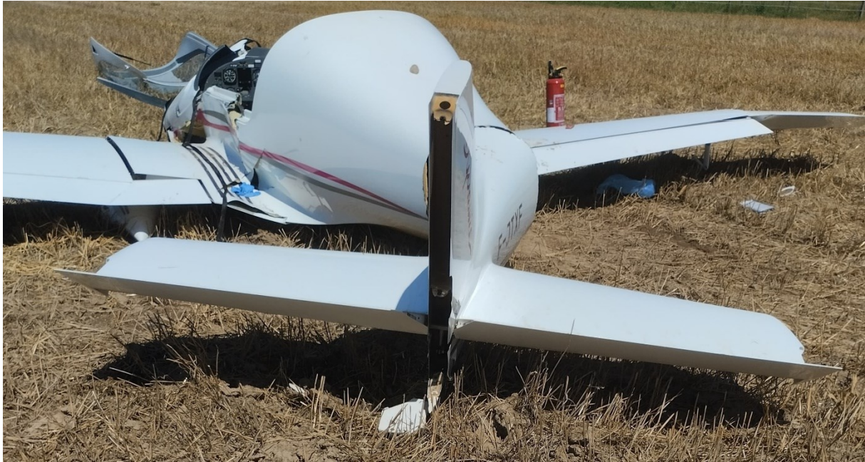
Figure 3 : rupture de l'arrière du fuselage (Source : BEA)
