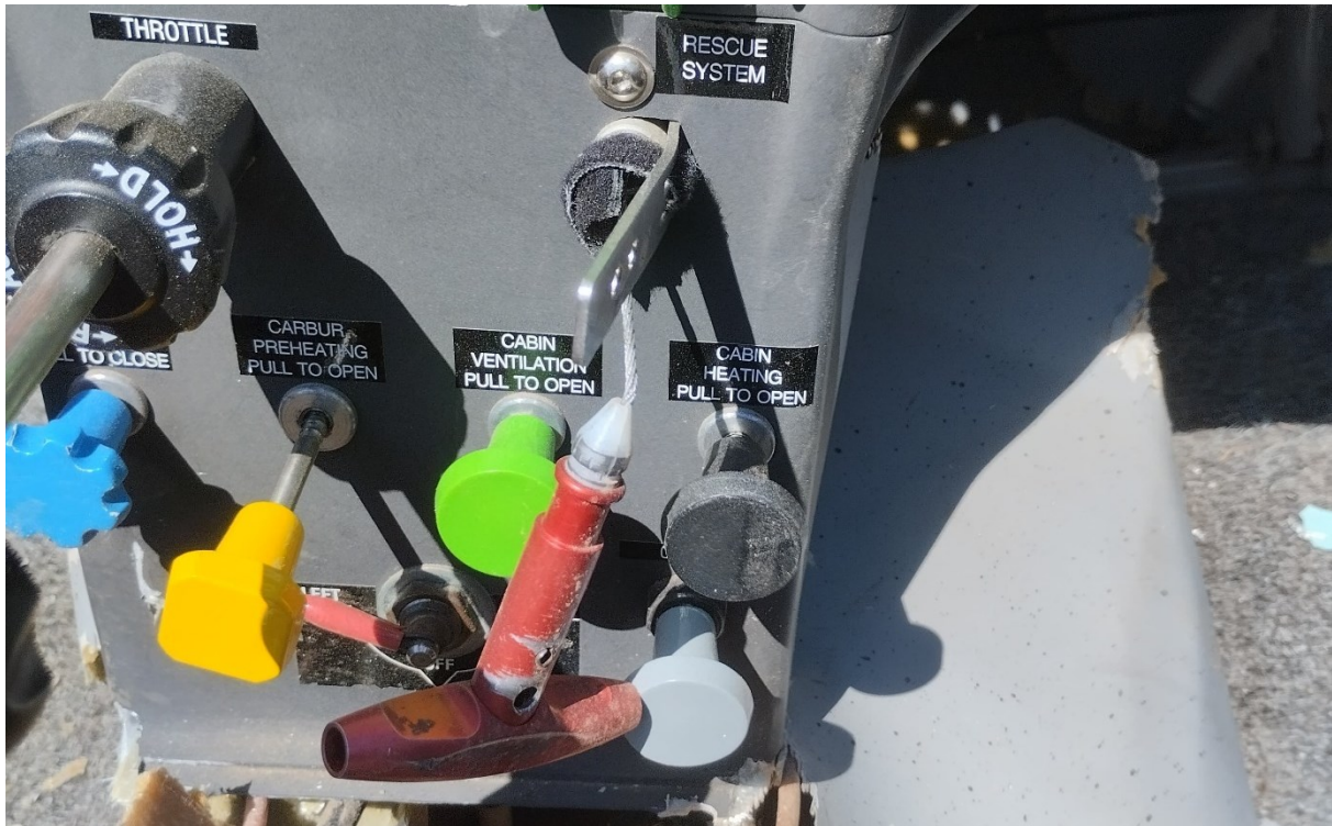
Figure 4 : position de la poignée du parachute de secours après l'accident (Source : BEA)
