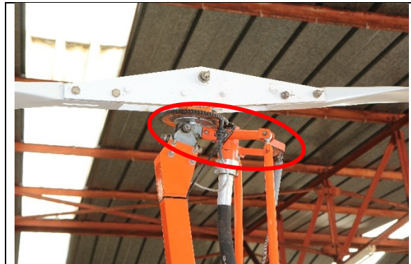
Figure 2 : tête rotor d'un autogire similaire (Source : BEA)
