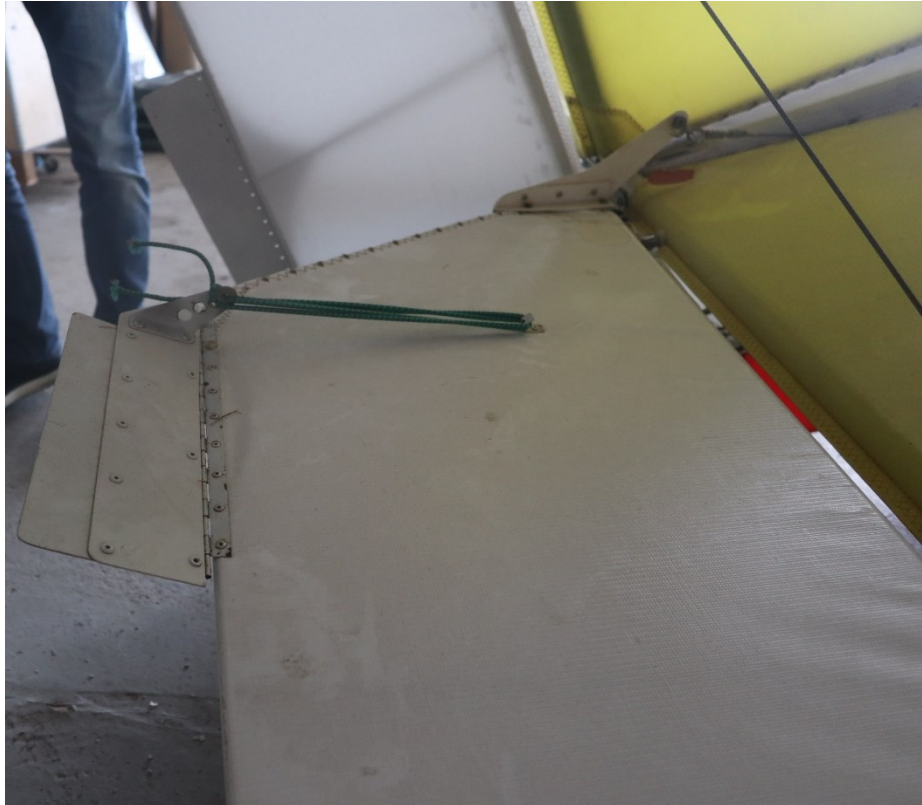
Figure 2 : volet du compensateur, câble élastique et extrados de gouverne de profondeur (Source : BEA)
