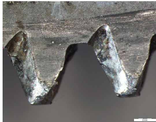
Figure 5 : vues détaillées des dommages sur les dents de la roue dentée
