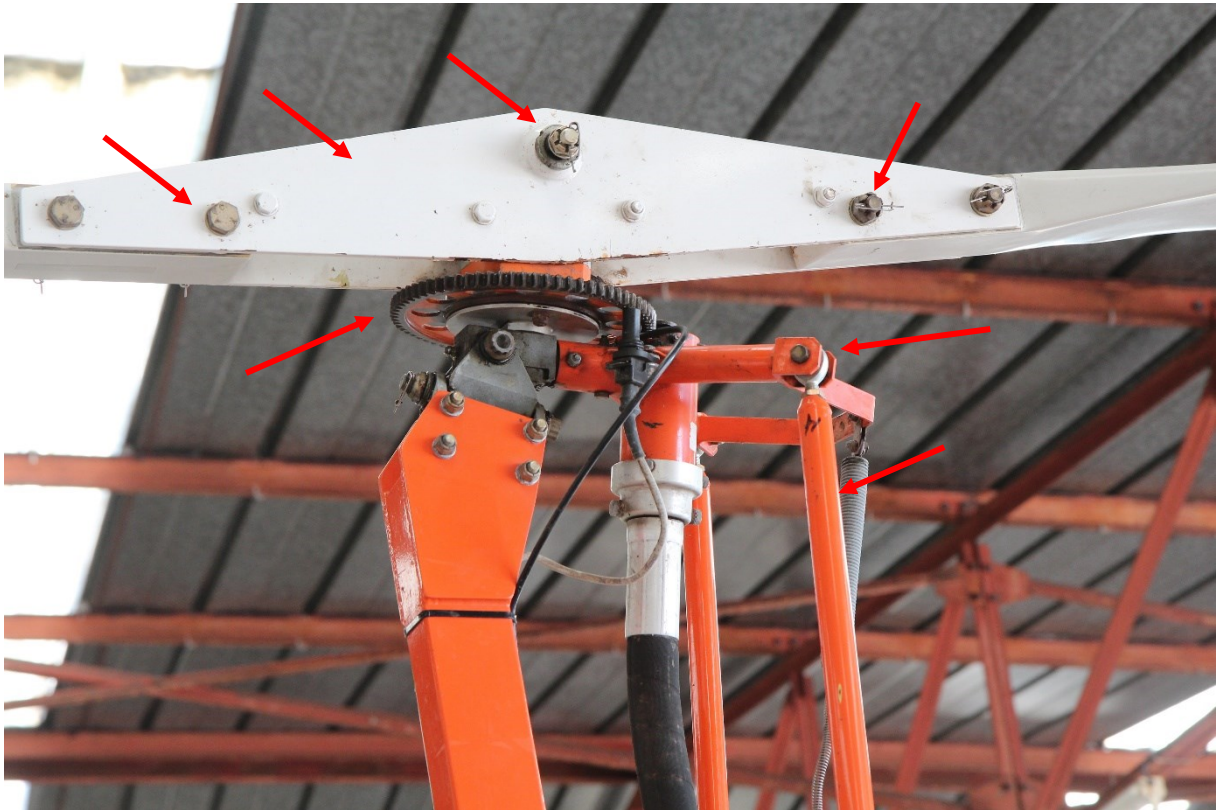
Figure 6 : points de vérification prévus sur le rotor et la partie haute de la chaîne de commandes d'un Magni M16
