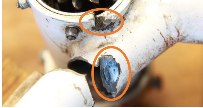
Figure 4 : rupture du bras droit et endommagement du tube vertical de la fourche (vue de dessus)
