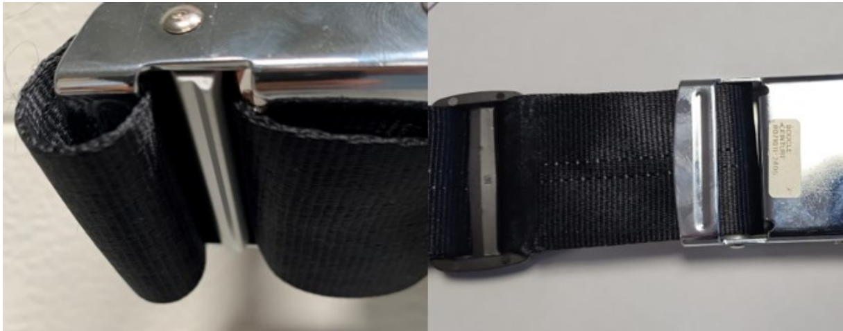
Figure 10 : À gauche, montage correct de la sangle sur la boucle métallique femelle, à droite montage à l'envers (Source : BEA/Air Création)
