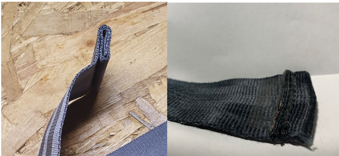
Figure 9 : détail des sangles textiles et ourlet : à gauche, sangle Anjou Aéro, à droite sangle montée sur l'ULM Air Création (Source : Anjou Aéro/BEA)
