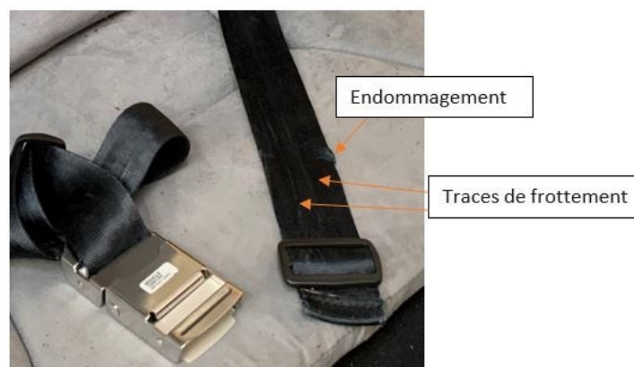
Figure 4 : sangles ventrales de la ceinture du pilote : à gauche les boucles d'attache (mâle et femelle) connectées, à droite la sangle détachée de la boucle femelle (Source : BEA)
