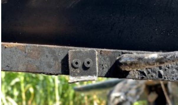
Figure 9 : ferrure de la verrière côté gauche (source : BEA)
