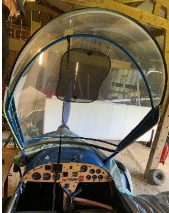
Figure 4 : photo de la verrière ouverte d'un autre ZT610 (source : BEA)
