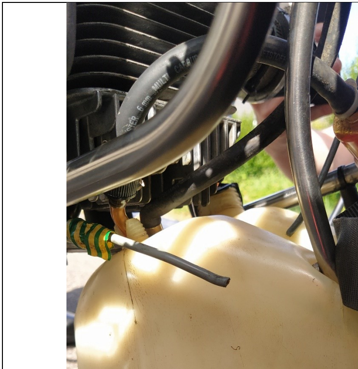
Figure 1 : bougie entourée de ruban adhésif isolant, câble d’alimentation rompu (Source : BEA)
