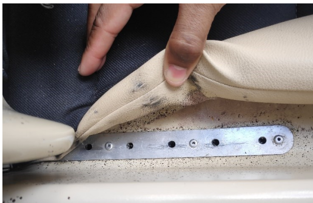
Figure 5 : fixation de l'assise du siège dans le plancher (Source : Papangue ULM)
