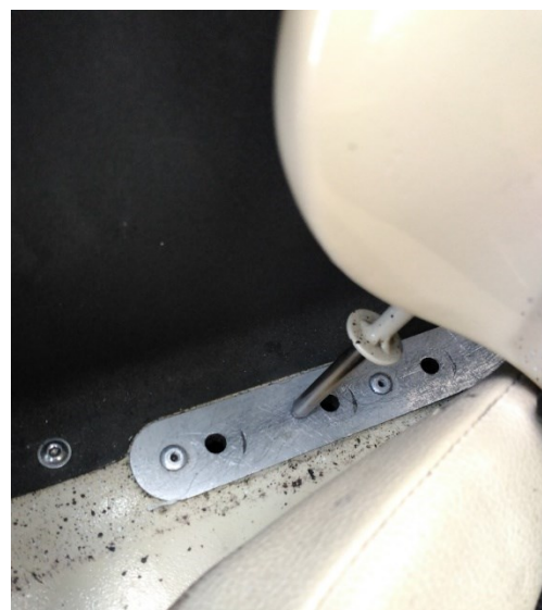
Figure 5 : fixation de l'assise du siège dans le plancher (Source : Papangue ULM)
