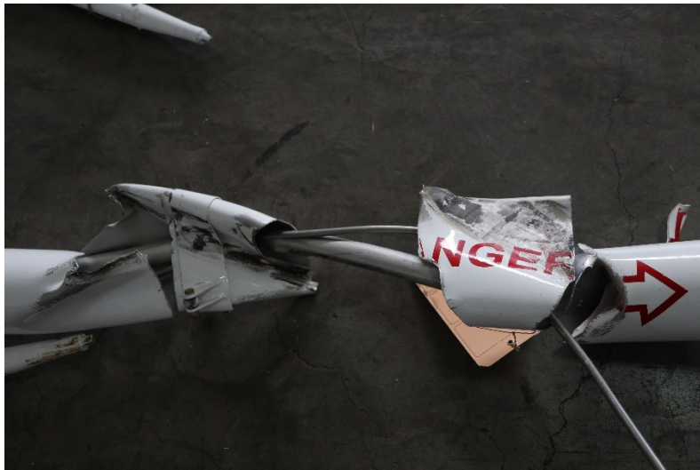
Figure 4 : traces d'interactions des pales du rotor avec la poutre de queue (Source : BEA)
