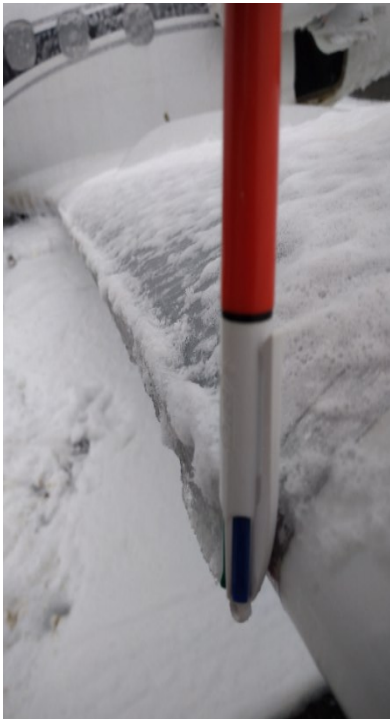
Figure 2 : givrage sur le bord d'attaque de l'aile gauche encore observé trois heures après l'accident. Les traces blanches sur l'extrados de l'aile sont les résidus du produit utilisé par les pompiers. (Source : BEA)
