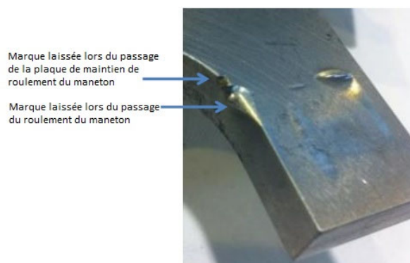
Figure 17 : marques sur le côté de l'oreille du plateau avant de la pale n°3
