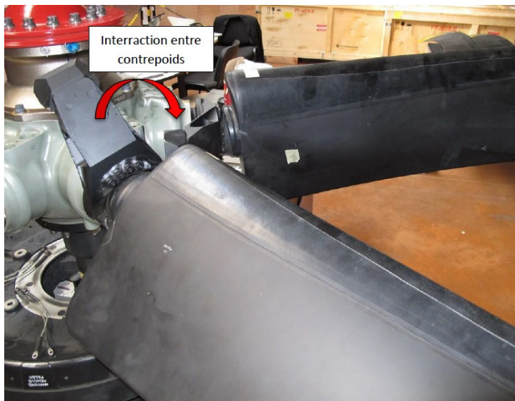
Figure 21 : interaction entre le contreponds de la pale n°4 et le bras de contreponds de la pale n°5
