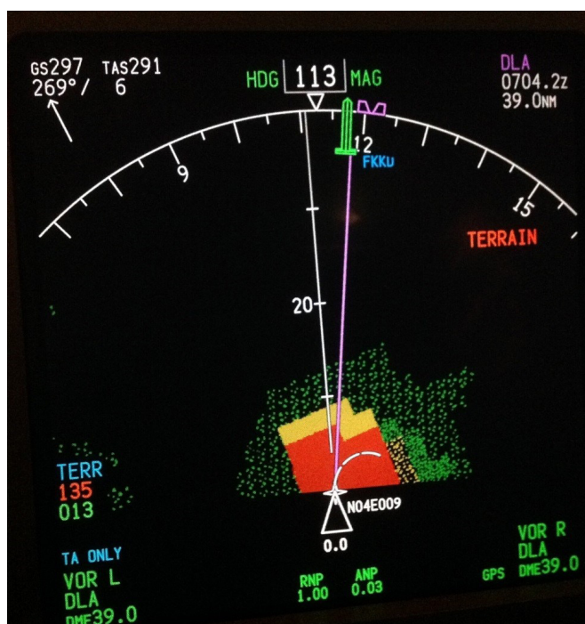
Figure 6 : Exemple d'affichage d'une alarme EGPWS TERRAIN sur le ND
