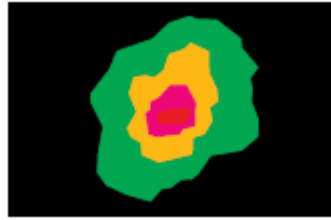
Figure 5 : Exemple d'affichage d'écho radar sur le ND
