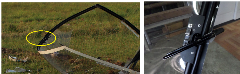
Figure 2 : Poignée en position non verrouillée (n'est pas en place dans son ressort de maintien)
