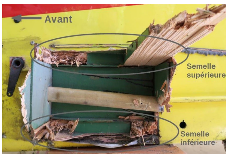
Figure 2 : Vue de la zone de rupture du longeron, prise vers le fuselage
