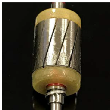
Figure 9 : Rotor avec présence d'une substance visqueuse
