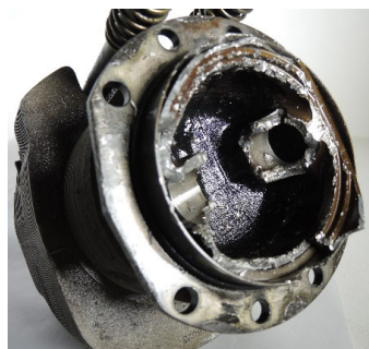
Figure 6 : Piston partiellement détruit bloqué dans le cylindre
