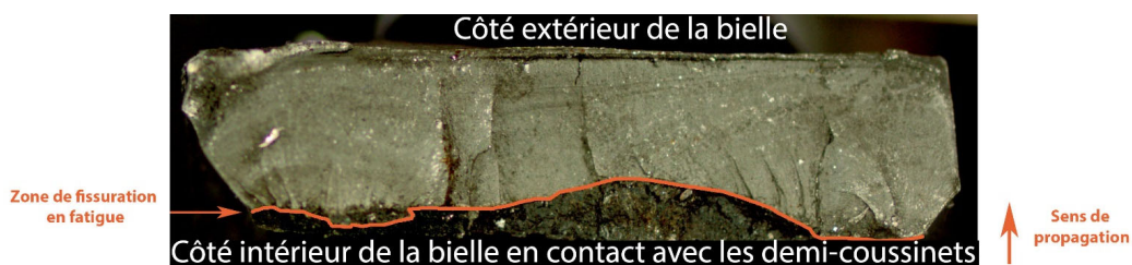
Figure 8 : Faciès de rupture de la bielle 1
