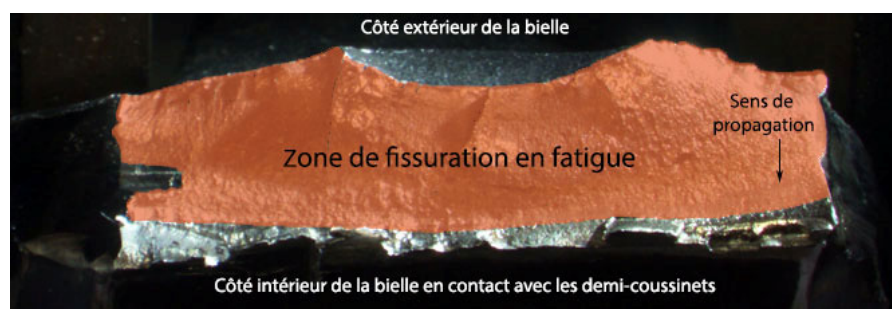
Figure 10 : Faciès de rupture sur F-HNCM
