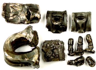
Figure 5 : Débris de la bielle
