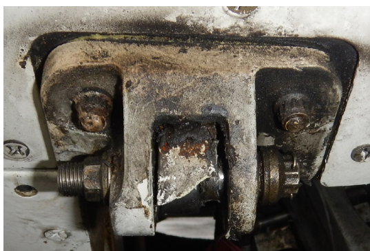
Figure 3 : Partie restante de l'assemblage attache arrière
