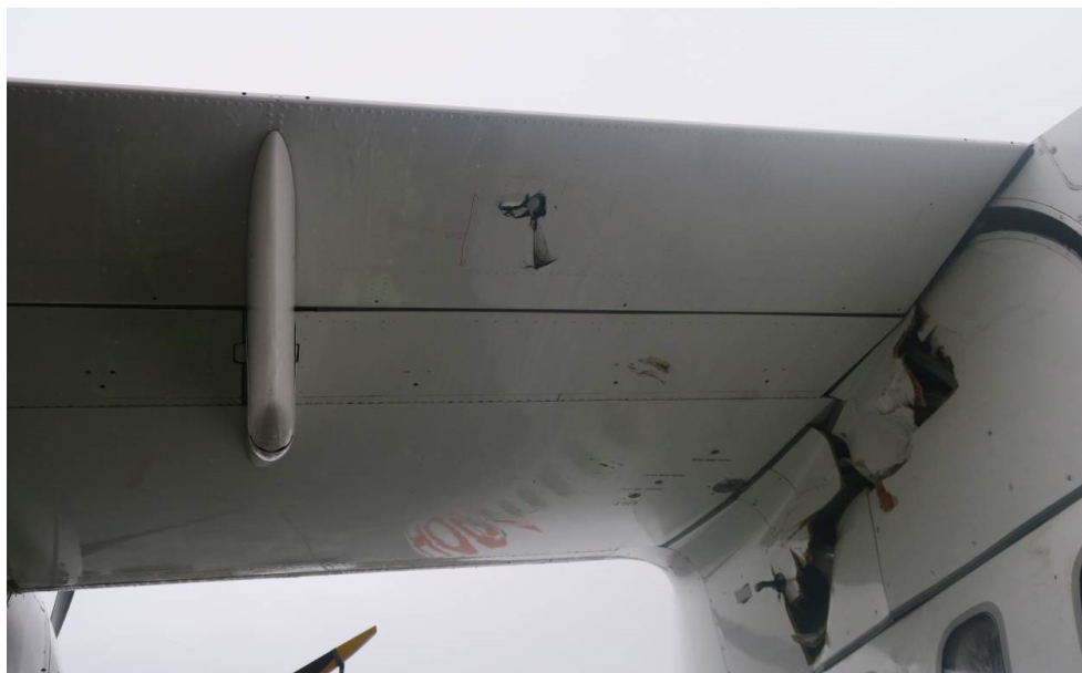
Figure 1 : Dommages au niveau de l'emplanture de l'aile et absence de la trappe du TPG
