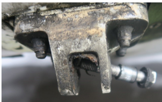
Figure 3 : Partie restante de l'assemblage attache arrière
