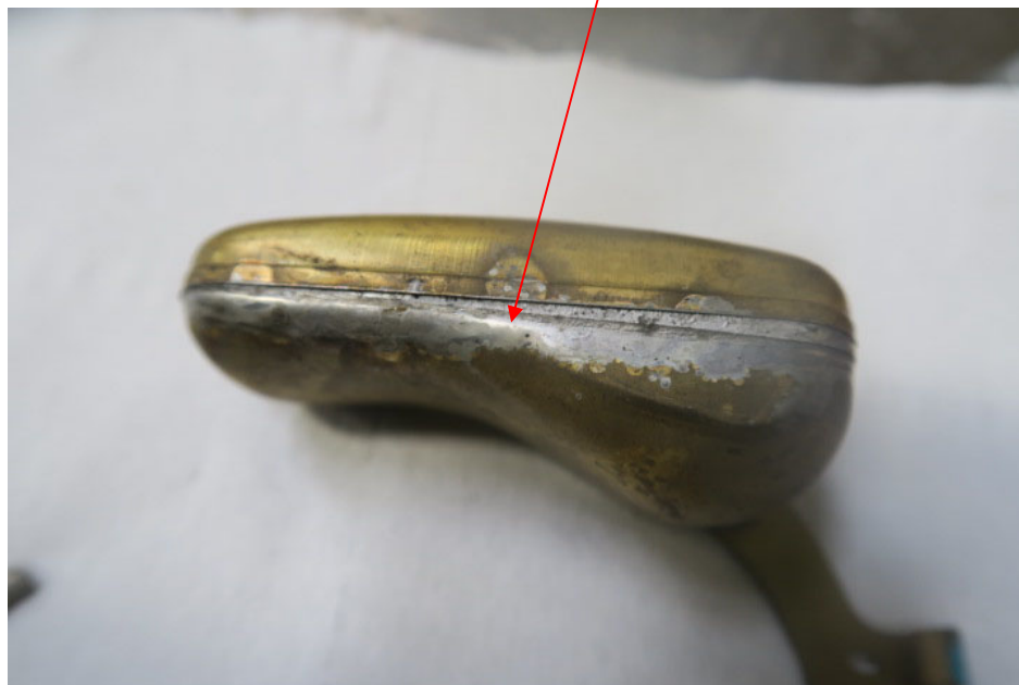
Figure 2 : Zone de brasure non nominale entre les deux demi-coques d'un flotteur
