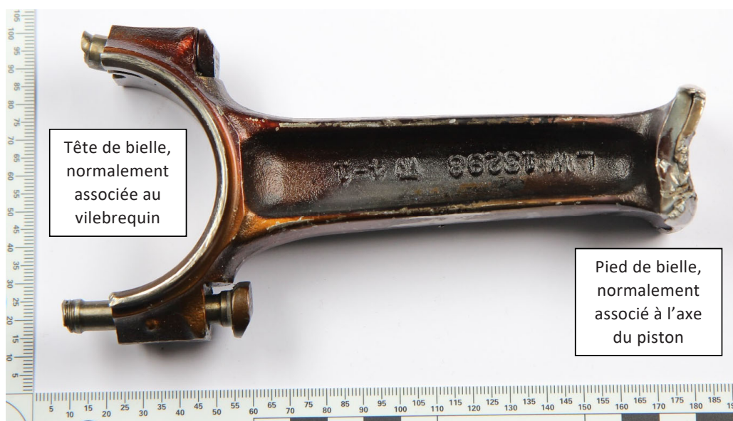
Figure 5 : Bielle du cylindre n°3
