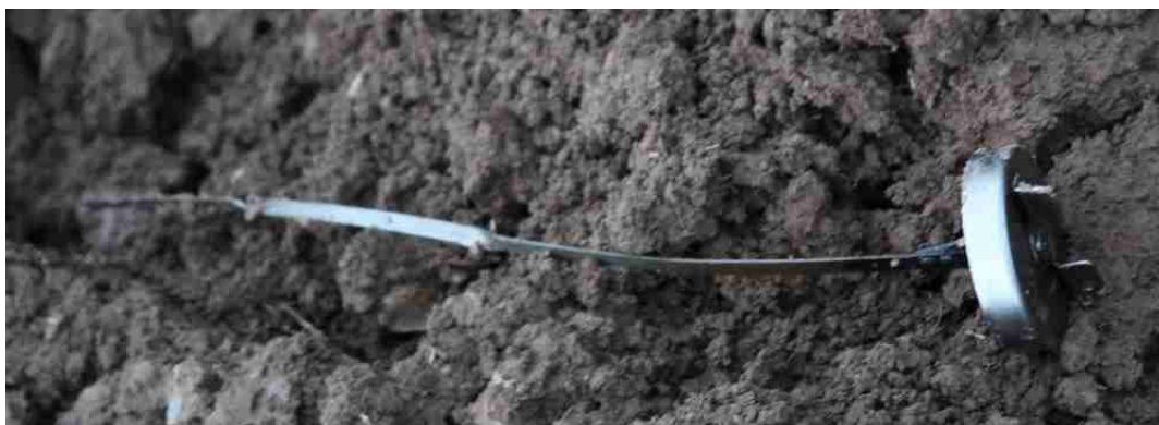
Figure 4 : Bouchon/jauge d'huile de type quart de tour
