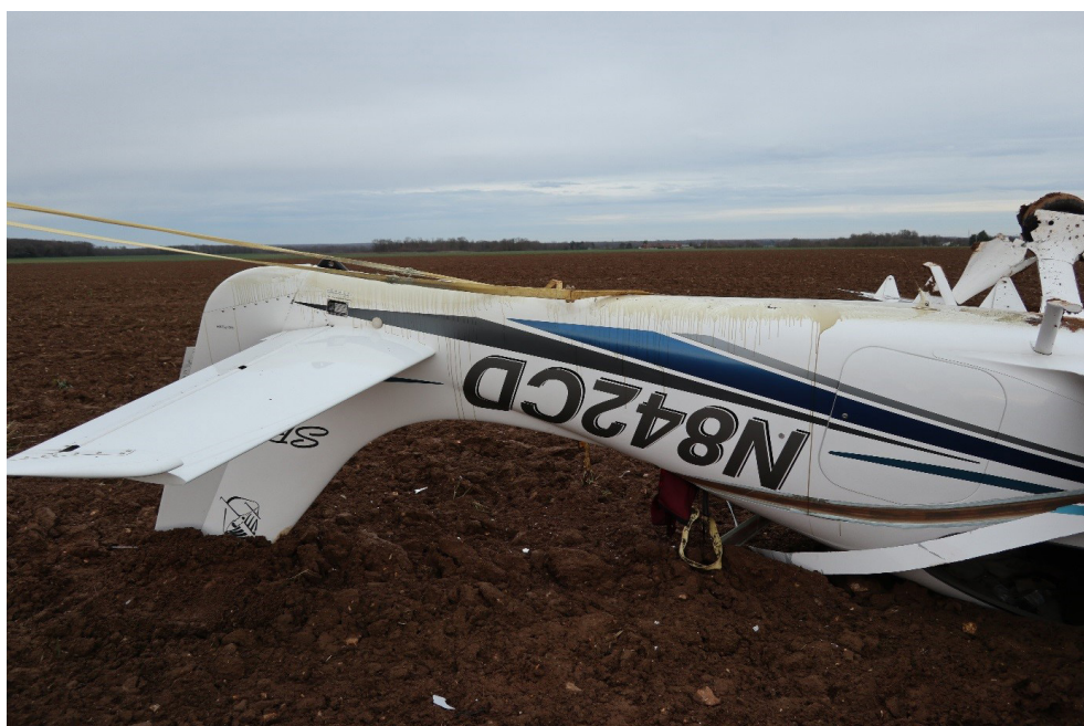
Figure 3 : Traces d'huile visibles sur le fuselage
