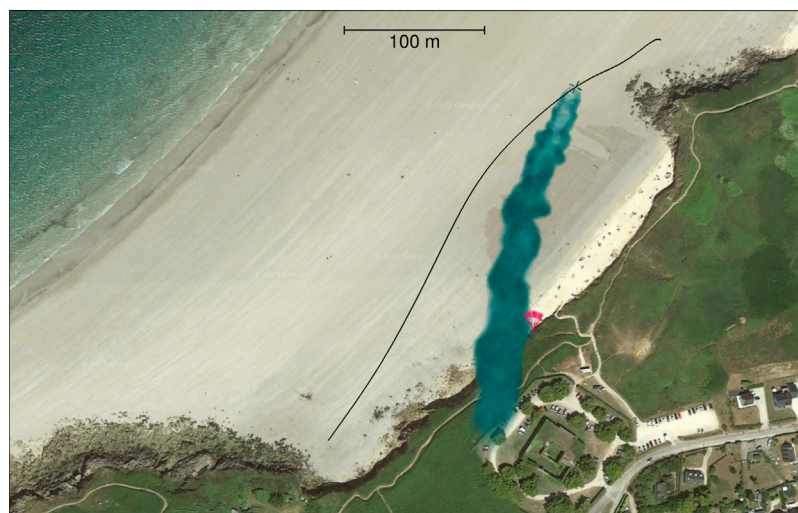
Figure 6 : Propagation de la turbulence de sillage calculée représentée par un flux bleu
