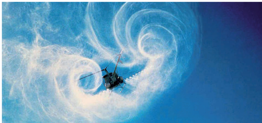
Figure 5 : Turbulences de sillage hélicoptère
