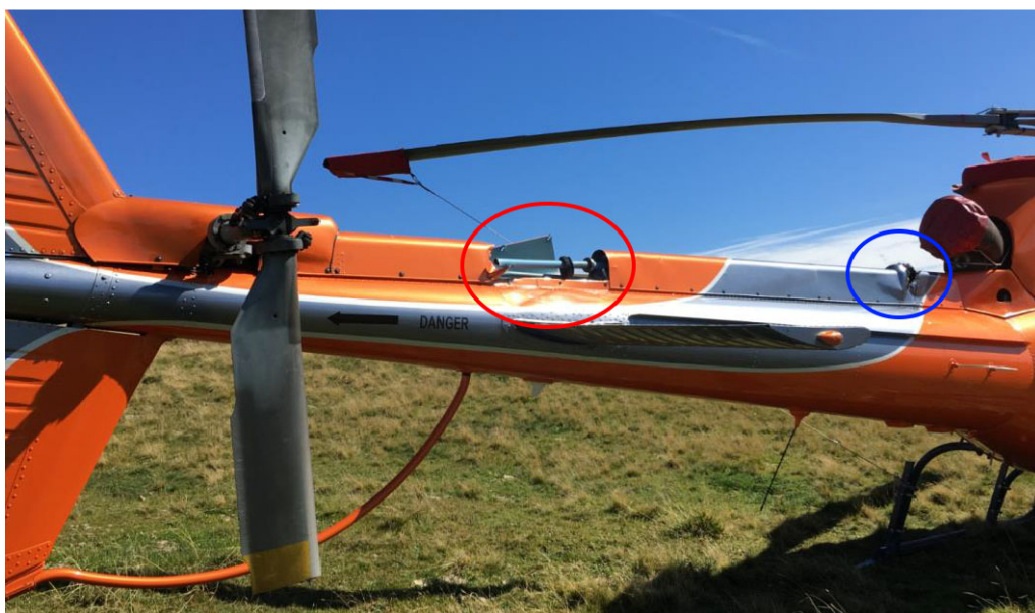
Figure 3 : Dommages externes sur la poutre de queue
