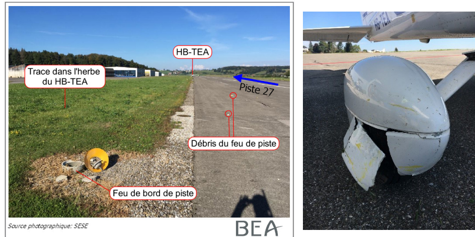
Figure 1: Dégâts engendrés au feu de bord de piste et au carénage de la roue du train d'atterrissage droit
