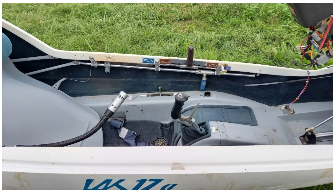
Figure 2 : Poste de pilotage du LAK17 En bleu la commande d'aérofreins, en gris la commande de volets
