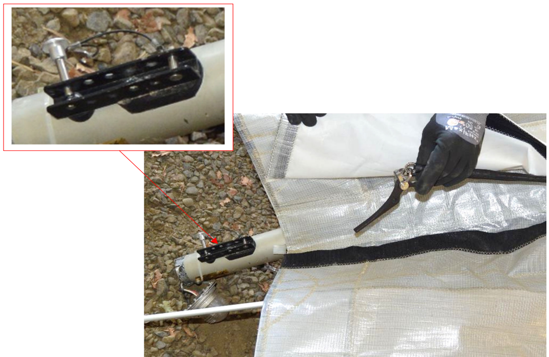
Figure 4 : Dispositif d'étarquage tel que retrouvé sur l'aile
