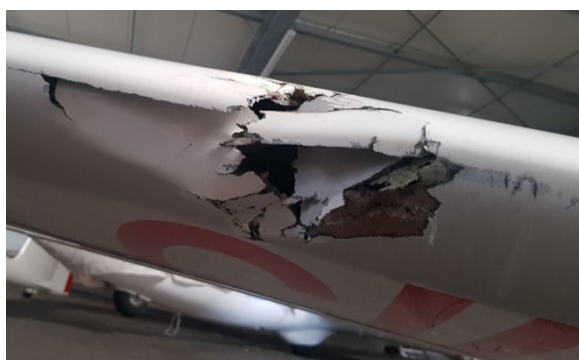
Figure 2 : Dommages sur le bord d'attaque de l'aile gauche
