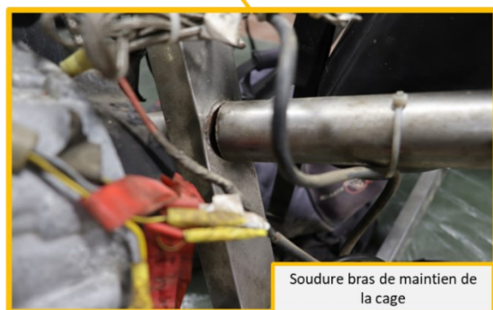
Figure 4 : ruptures au niveau des soudures du chariot (Source : BEA)
